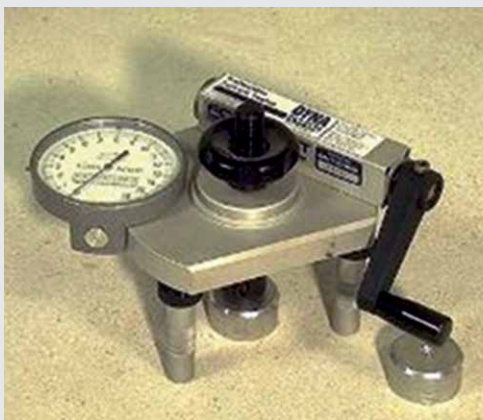
Fig. 2.2 - Instrument pentru determinarea rezistenței la smulgere (Pull off tester)
