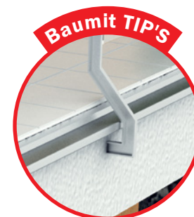
Fixați balustrada din partea laterală a plăcii
