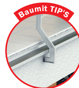
Fixați balustrada din partea laterală a plăcii
