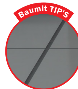
Rosturi de dilatație la suprafețe de max. 3x3 m sau raport între laturi 1:2
