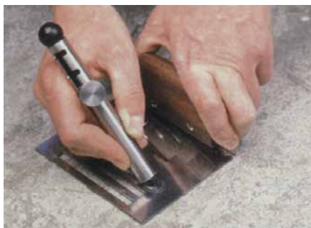
Testarea suportului cu ajutorul unui tester
