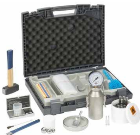
Trusa de măsurare a umidității prin metoda cu carbură de calciu - CM.
