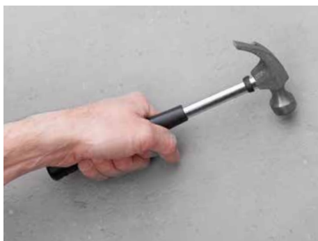
Starea suportului poate fi evaluată cu ușurință, prin baterea cu un ciocan.
