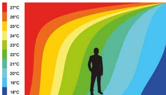
Distribuția temperaturii în încăpere pentru încălzire tradițională și încălzire prin pardoseală.
